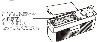
アルカリ乾電池をセットして、電源が入ることを確認してください。右図のように本体をセットします。
