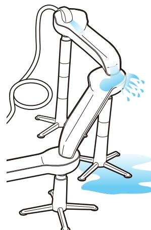
水が飛び散る場合は、コース角度や傾斜角度を調整してください。
